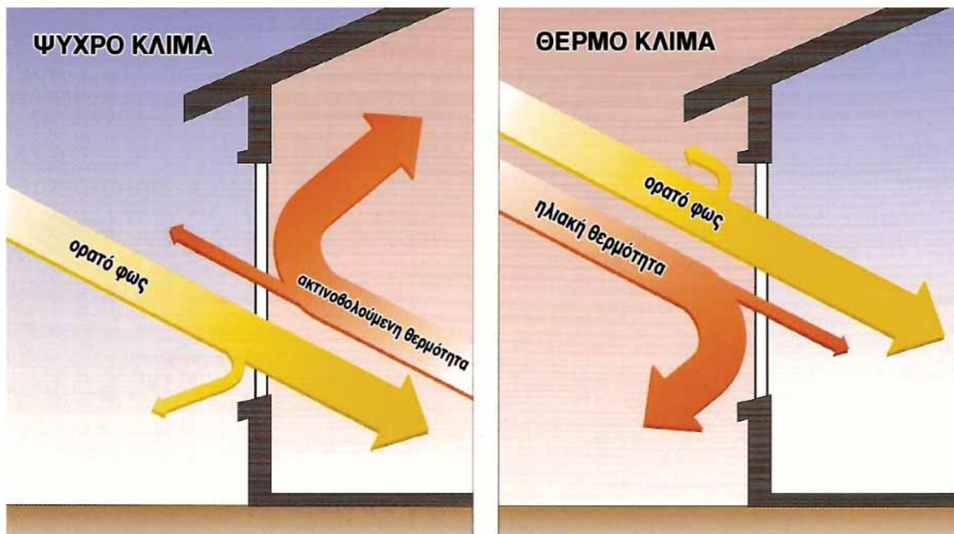
ΕΙΚΟΝΑ 36: Τα Low-E γυαλιά, τον χειμώνα δεν επιτρέπουν την απώλεια θερμότητας, ενώ το καλοκαίρι κρατούν τη ζέση έξω από τον χώρο επιτρέποντας την διέλευση του φωτός.
